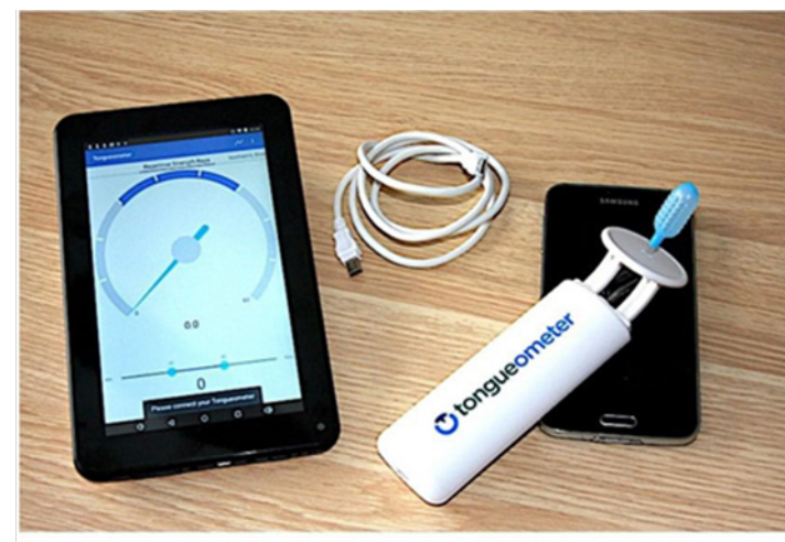
Фиг. 2. Уред за измерване на силата и издръжливостта на езика Tongueometer
